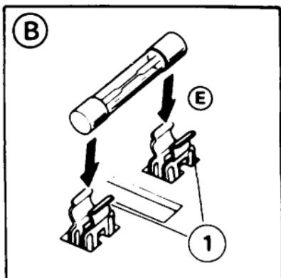
**ATTENTION:** Ne pas écarter les supports pour sortir un fusible, cela pourrait les déformer et causer une mauvais contact avec le nouveau fusible. Un fusible mal supporté peut endommager le circuit électrique et peut aussi causer un incendie.
